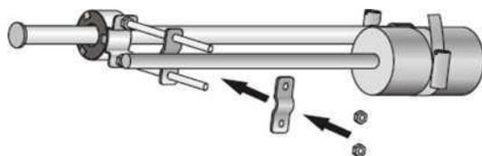
Третий шаг: поставьте стопорную шайбу и зафиксируйте ось цилиндра.
